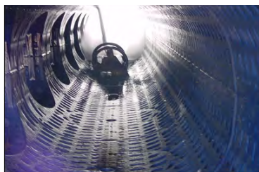
Photo 2.10 : Canal de diffusion susceptible d'être curé
